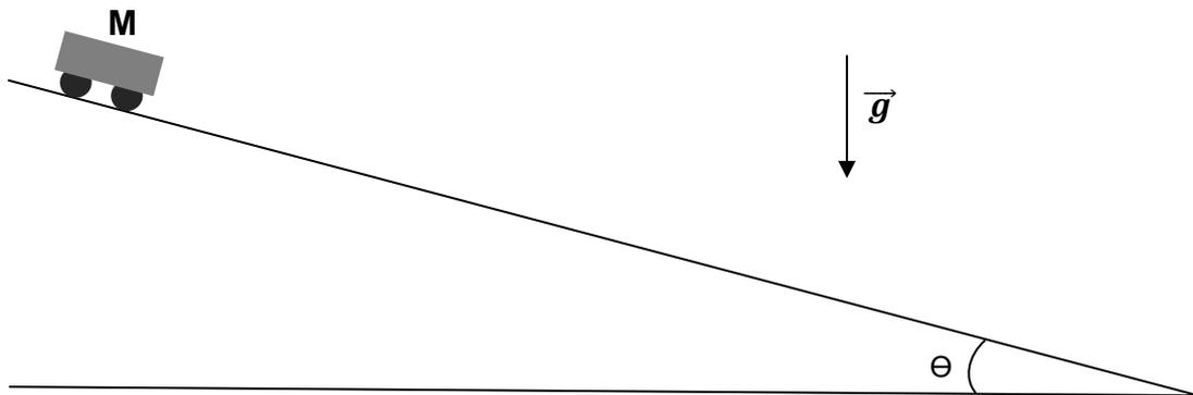
Un chariot de masse totale  $M$  est doté de quatre roues cylindriques ( $m, r$ ). Il est placé sur un plan incliné de longueur  $L$  et d'inclinaison  $\Theta$ .
