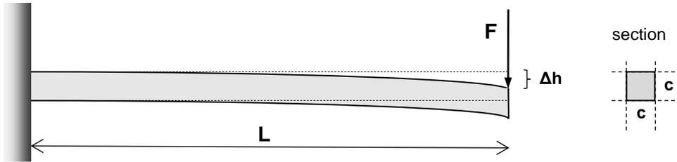
Dans une première expérience, on fixe au mur une barre ayant  $c = 12$  mm et  $L = 55$  cm. Puis on fait varier l'intensité de la force  $F$ . On reporte les mesures de  $\Delta h$  dans le Tableau n°1.
